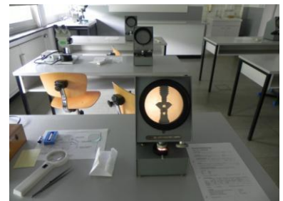
Mit dem Proportionskope lassen sich die Proportionen und einige Symmetriemerkmale bei runden Brillanten und modifizierten Brillantschliffen in Prozent ermitteln.
