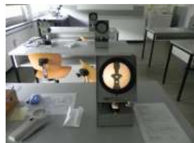
Mit dem Proportionskopspektroskop lassen sich die Proportionen und einige Symmetriemerkmale bei runden Brillanten und modifizierten Brillantschliffen in Prozent ermitteln.
