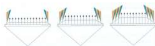
Abhängigkeit der Dispersion von der Größe der Oberteilfacetten. Diamanten-Fibel, S. 184
